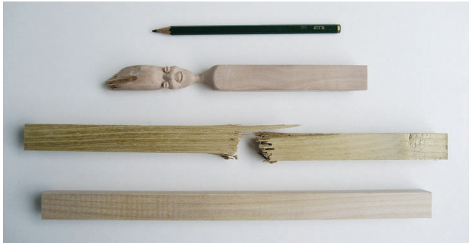
/ Vom Rohling zur fertigen Figur: Ein quadratischer Holzstab vor und nach dem Bruchtest auf dem Pendelschlagwerk und eine beschnittene Figurenstele – darüber ein Bleistift zum Größenvergleich. (Foto: Järmo Stablo)
