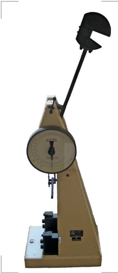
/ Auf solch einem Pendelschlagwerk entstehen die Rohlinge der Bruchtestmännchen
